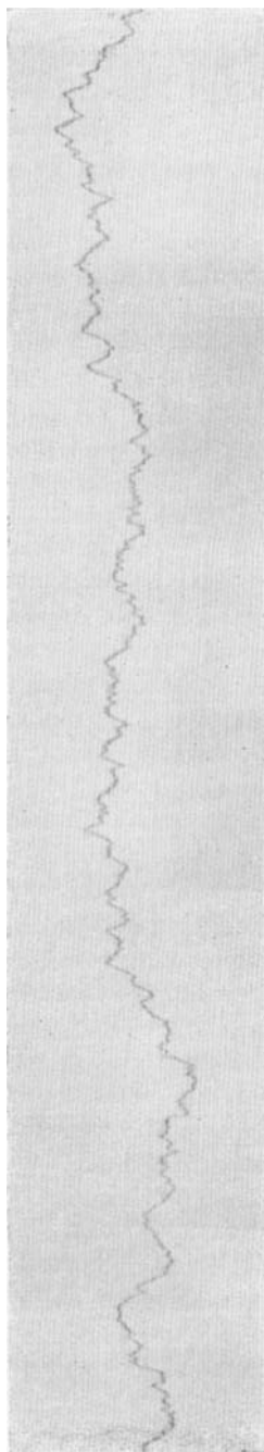
Registrieraufnahme der Brownschen Bewegung (natürliche Größe). Direktionskraft 9,428 \cdot 10^{-9} abs. Einh. Trägheitsmoment: 1 \cdot 10^{-7} abs. Einh. Abstand Spiegel-Kamera: 72,1 cm. Zeitmarke: 30 sec dx = 1 mm. a) Atmosphärendruck. Temperatur 13^{\circ} C
